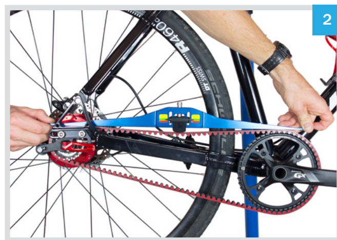
Meet de riemspanning over de hele overspanning door beide tandwielen met elkaar in contact te brengen.
